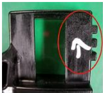
対策前 ガス焼け有り(矢印先は0.1mm)
